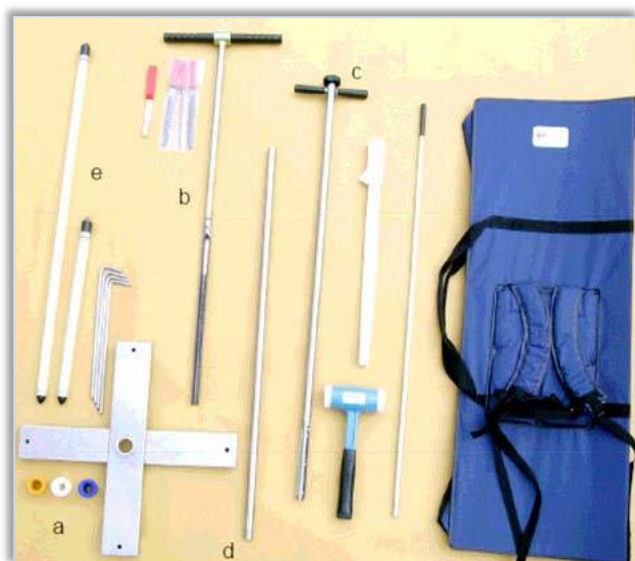
(a) plaque de stabilisation (b) tarière pilote (c) tarière de finition (d) tige d'insertion (e) tubes d'accès courts et longs
