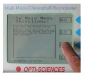
L'OSI 5-P est léger et fonctionne sur batterie (20 h d'utilisation continue), il reste compact et complètement intégré, avec un écran à large affichage graphique et une capacité mémoire illimitée (via Carte SD). Un PC n'est pas nécessaire!
