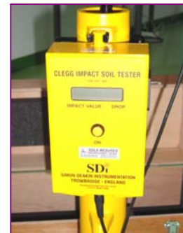
Vue du Compactomètre CLEGG léger, 4,5 kg, montré près de sa caisse de transport
