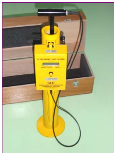
Vue du Compactomètre CLEGG léger, 4,5 kg, montré près de sa caisse de transport
