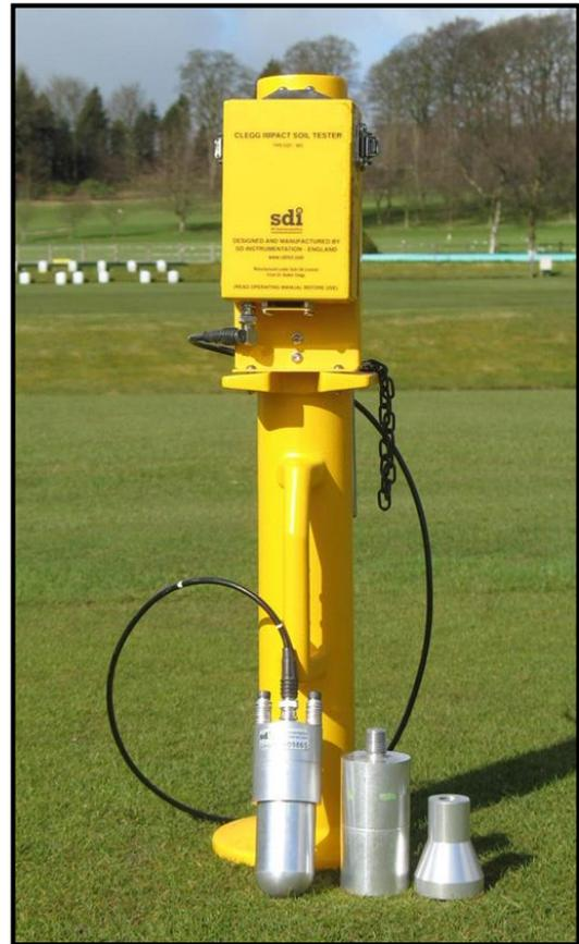
**Transfert des informations sans fil via Bluetooth :** L'électronique à bord du module « accéléromètre » sauvegarde les données et les transmet au boîtier de contrôle, sans fil, via la liaison Bluetooth. De même, l'utilisateur peut aisément transférer les données stockées dans le boîtier vers son PC. La liaison Bluetooth s'installe via un programme dédié et une clé USB ; de même le programme de transfert des données au format Excel est fourni par SDI.
