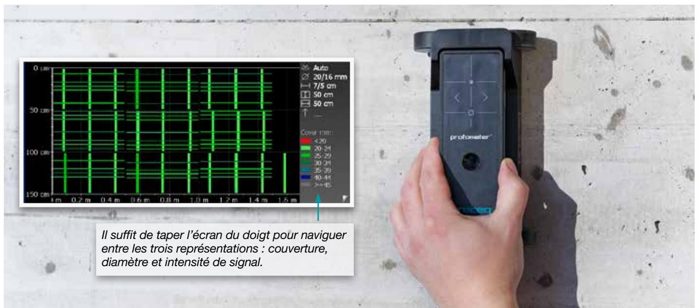
*Il suffit de taper l'écran du doigt pour naviguer entre les trois représentations : couverture, diamètre et intensité de signal.*
