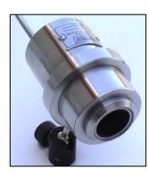
Référence : 4000.3 (mode séquentiel ou analogique, distance d'utilisation 2 cm à 300 m, gamme -40... +100 ± 0,5 °C, contrôle du système optique par microprocesseur et chopper électronique, ajustement électronique de l'émissivité, temps de réponse 0,100 s, 2 angles de visée (4° et 15°), conçu pour une utilisation dans des conditions atmosphériques difficiles)
