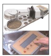
Technique : IRGA (analyse de gaz par infrarouge) dans la chambre
