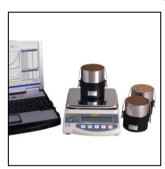
Technique: méthode d'évaporation de Wind/Schindler pour la détermination de courbes de rétention et de la conductivité hydraulique à partir d'échantillons de sol. Gamme +2...-120 kPa / -250 kPa Acquisition: directement par ordinateur sous logiciel TensioVIEW
