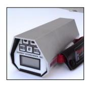
Référence: EVE 100.3 (gamme -40...+100 ± 0,5 °C, distance d'utilisation 2 cm à 300 m, mesure en mode séquentiel, contrôle du système optique par microprocesseur et chopper électronique, ajustement électronique de l'émissivité, temps de réponse 0,100 s, 2 angles de visée (4° et 15°))
