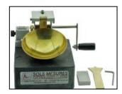
Limite de liquidité selon NF P94-051, appareil de Casagrande Constitution : 1 base pesante, 1 mécanisme de guidage, 1 coupelle lisse et son gabarit d'ajustement 10 mm, 1 compte-coups. *Références :*
