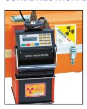
Technique: neutronique et gamma-neutronique Paramètres au choix : cnt, ratio, pcf, ipf, cpc, % Hv
