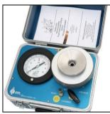
Technique: application d'une pression à l'aide d'une bouteille de gaz Gamme: de 20 à 70 bar (100 bar en option) selon modèle Matière de la chambre: aluminium ou acier inox selon modèle Lecture: manomètre à aiguille (précision ± 1% E.M) ou digital en option Couvercle à baïonnette à ouverture variable, avec volant de compression du joint obturateur
