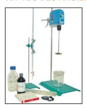
Technique : essai au bleu de méthylène dit A LA TACHE pour la détermination de l'activité et de la quantité de la fraction argileuse d'un échantillon, selon norme NF P 94-068 / EN-933.9
