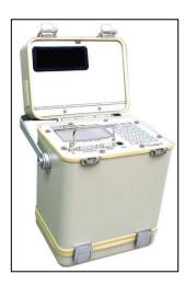
Technique: TDR (Time Domain Reflectometry) Gamme: 0...100% ± 2% humidité volumique (Hv) Paramètres : Ka, Hv (% d'eau), graphes des signaux Systèmes multiplexables pour des suivis continus
