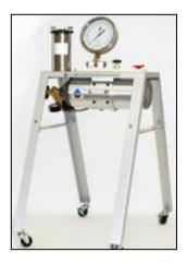
Technique : application d'une pression à l'aide d'une bouteille de gaz
