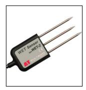
Technique : FDR (Frequency Domain Reflectometry sous 20MHz)
