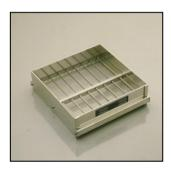
Paramètre mesuré : coefficient d'aplatissement ou coefficient de forme des granulats selon norme NF EN 933-3/A1
