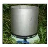
Applications : expérimentations en labo sur des colonnes de sol, ou in situ enterré pour récupérer les produits de lixiviation Lysimètre seul : cylindre acier inox + plaque céramique 0,5 bar HF
