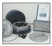
Analyse simultanée de la nitrification - dénitrification - respiration du sol Paramètres : volumes de  $CO_2$  et  $O_2$  en %, températures et pressions Incubateur : jusqu'à 7 cylindres à échantillons (CC : 100 ou 250 cc) Avantages : préservation de la structure des sols, pas d'application de
