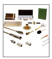
Technique: prélèvements d'échantillons 100 cm³ de sol non remaniés Applications: mesures de teneurs en eau volumique et massique à des potentiels hydriques variés, courbes pF de rétention pF, perméabilité à l'eau et à l'air, masse volumique, densité apparente
