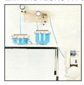
Technique : application d'une pression et extraction d'eau pour la mesure de la capacité de rétention en eau des sols Tableaux de distribution/régulation de pression pour un ou plusieurs extracteurs, alimentation par bouteille ou compresseur
