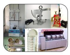
**Essais de compactage :** presse CBR, PROCTOR : détermination de la compacité - densité maximum à une teneur en eau donnée.
