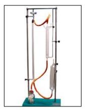
Technique: détermination du volume de  $CO_2$  dégagé sous l'action d'acide chlorhydrique en excès, selon NF P 94-048 / ISO 10693 (1995) Constitution: 1 cadre rigide à 2 colonnes reliées par 2 traverses horizontales, 1 flacon type ampoule de niveau ouvert à l'atmosphère, 1 burette graduée 200 cc, des tubulures souples reliant l'ampoule et la burette, 1 burette-tube réfrigérant, 1 tube réfrigérant-flacon à réaction, 1 cristallisoir 3L pour contenir le tube réfrigérant et 1 jeu de 4 tubes à essai
