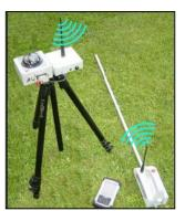
Technique : mesure de PAR sur 60 photodiodes individuelles et calcul
