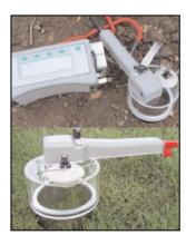
Technique : IRGA (analyse de gaz par infrarouge) dans la chambre
