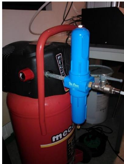
Les compresseurs d'air présentés ici constituent la source de pression sélectionnée pour alimenter les tableaux de distribution de pression constante type air/eau ou une série d'oedomètres pneumatiques type Acons.
