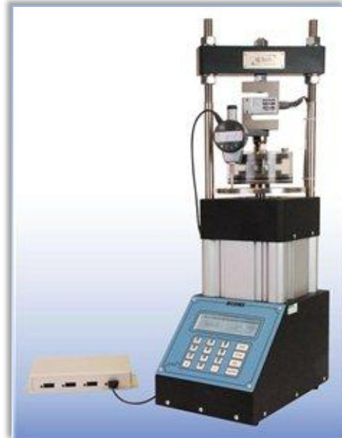
Un comparateur digital ou un capteur de déplacement analogique type LSCT de 25mm est à prévoir en sus. Le LSCT se connecte directement à l'arrière de l'appareil, le digital doit être connecté sur un module interface supplémentaire.
