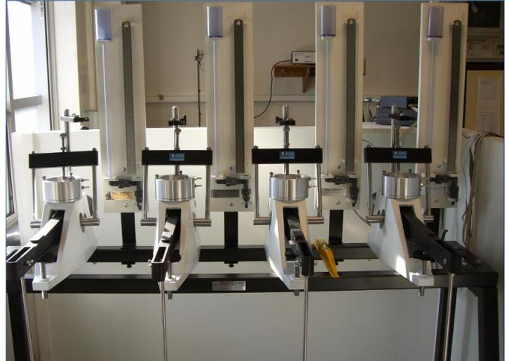
Ex : Oedomètres sur un support acier démontable
